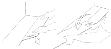
2. LÄGGNING AV ANDRA RADEN.
